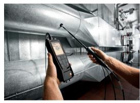
通风管道的风量测定与调整需要通过风速探头来实现。testo 480 的风速探头自带伸缩手柄,可以确认深入深度,同时内置栅格测量法,引导客户轻松实现专业测量。
