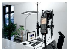
testo 480 提供多种智能探头,用于记录工作场所人体舒适度及空气品质的相关参数。内置的紊流度及 PMV/PPD 测量程序可以直观的显示室内环境的舒适度。
