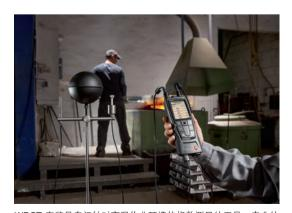
WBGT 套装是专门针对高温作业环境热指数测量的工具,专业的 WBGT 探头及 WBGT 测量程序可以测量计算出环境的热指数, 反应热负荷强度。
